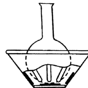
Fig. 14. b. Baie de aer conică.
